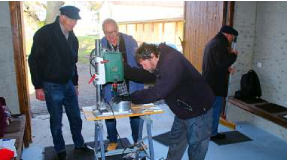
Arbeitseinsatz: Der Zwischenflansch wird neu gebohrt.
